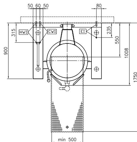
Pentola elettrica basculante 60 lt. (h), carico automatico acqua calda/fredda con rubinetto, doccetta, kit di chiusura posteriore
